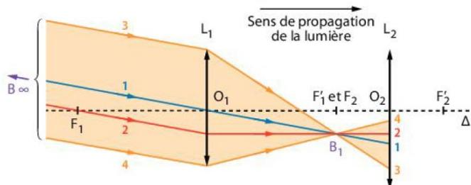
Étape 2 : construction du faisceau émergeant de l'oculaire
